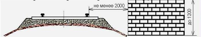
Расстояние до крайнего рельса при высоте груза выше 1200 мм
