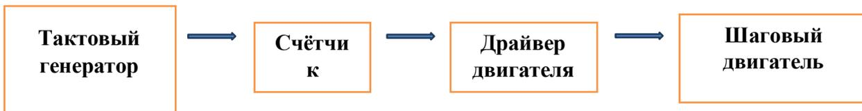
Рисунок 1 – Блок схема системы управления шаговым двигателем
