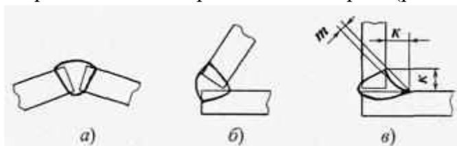
Рис. 1.3. Угловые соединения
